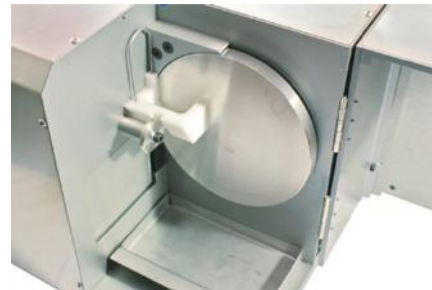
Messprinzip rotierende Scheibe (3 Winkel)
